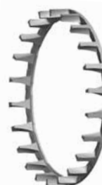
Fig. 9. Porta-rolos bipartido tipo pente usinado em bronze guiado pelo anel interno
