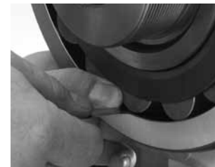
Fig. 15. Durante a montagem, a RIC deve ser verificada no rolo que não tiver carga.
