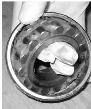
Fig. 21. A graxa pode ser aplicada facilmente com as mãos
