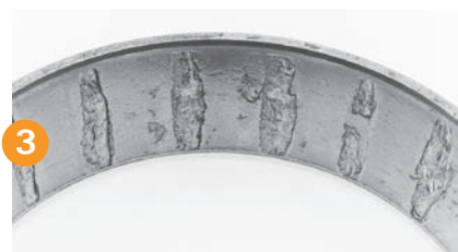
Linhas de descascamento Linhas de descascamento espaçadas pelos rolos, em rolamentos mantidos em serviço após falha por corrosão.
