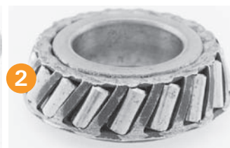
Travamento e inclinação dos rolos Compressão do anel do porta-rolos na instalação ou interferência durante o funcionamento.
