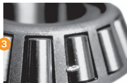
Ranhuras Estilhaços maiores se alojam no material flexível do porta-rolos.
