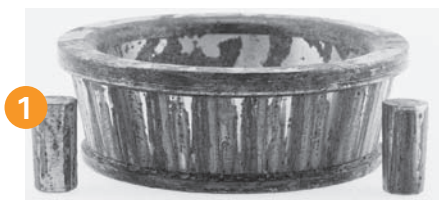
Oxidação Corrosão causada por umidade ou água, formando pequenas cavidades.
