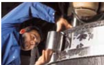
Inspeção do assento de um rolo
